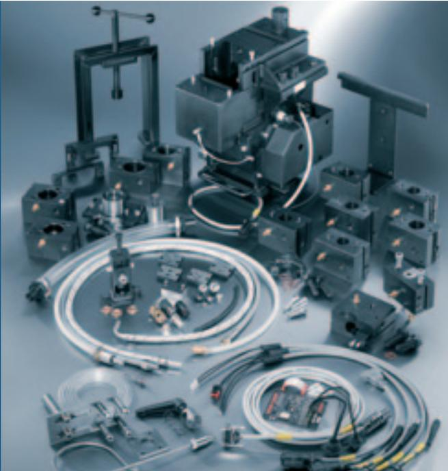
Grundlage für die Prüfung von Unit-Injector- und Unit-Pump-Systemen ist der **Nachrüstsatz CAM 847 Komplettpaket**.
