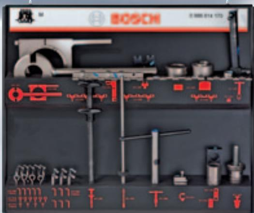
Instandsetzung von Reiheneinspritzpumpen der Baureihen PE(S) ..M.. mit und ohne Förderbeginnebersystem (FBG-System), **ohne** Regler, atmosphärendruckabhängiger Volllastanschlag (ADA) und Spritzversteller
