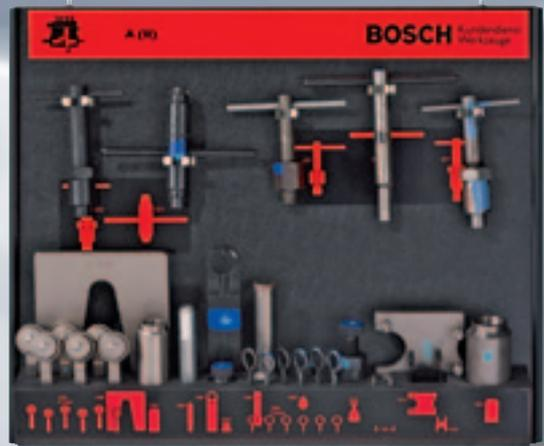
Instandsetzung von Reiheneinspritzpumpen der Bau-
