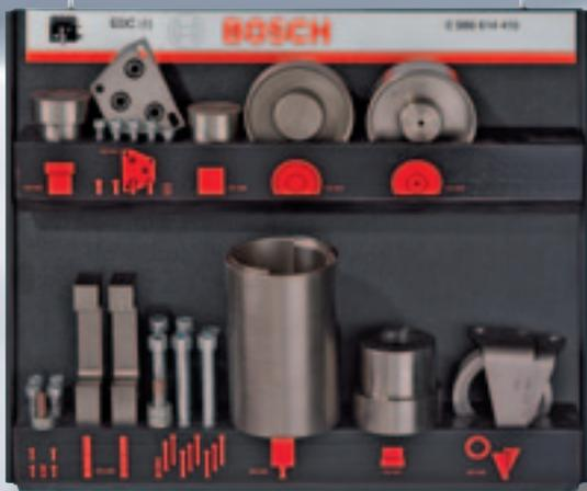
**Werkzeugsatz** für die Instandsetzung von Stellwerken (RE-Stellwerke) von elektronischen Reglern der Reiheneinspritzpumpen der Baugrößen R, M
