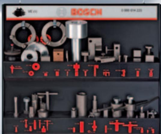
Werkzeugsatz für die Instandsetzung von mechanisch geregelten Verteilereinspritzpumpen (VE)
